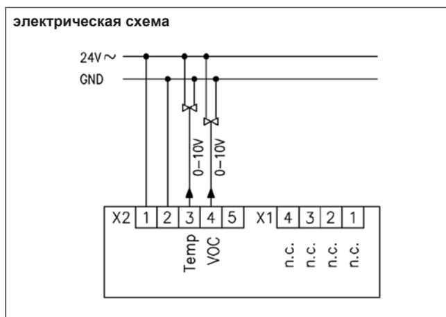
После повторного пуска или исчезновения напряжения выдаётся 100% сигнал для максимальной вентиляции в течение 20 минут. В течение этого времени датчик качества воздуха воспринимает актуальное значение VOC как основное значение 450 мг/м<sup>3</sup>. Выдаваемый в результате этого сигнал 1,125 В (ок. 11%) обеспечивает основную вентиляцию. При улучшении качества воздуха происходит автоматическая корректировка основного значения.
